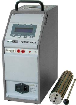
Der Metallblock-Temperaturkalibrator LR-Cal PULSAR-80Cu besteht aus einem Metallblock mit Durchmesser 80 x Tiefe 300 mm, der durch einen Heizwiderstand, der außen um den Block gewickelt ist, beheizt wird. Die Öffnung des Blocks beträgt 60 mm Durchmesser x 275 mm Tiefe. Hierfür stehen kundenspezifische Blockeinsätze zur Verfügung.
