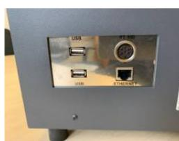
Alle 3 Modelle verfügen über zwei USB- und einen Ethernet-Anschluss sowie Buchse für ext. Referenz-Sensor.
