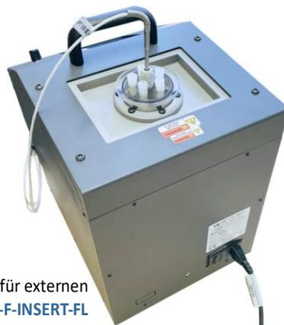
Die Abbildung zeigt das Gerät mit optionalem Eingang für externen Referenzsensor und optionalem externen Fühler. **LTC-F-INSERT-FL** mit optionalem Behälterdeckel mit Bohrungen Art.Nr. **LTC-F-DECKEL-05**.
