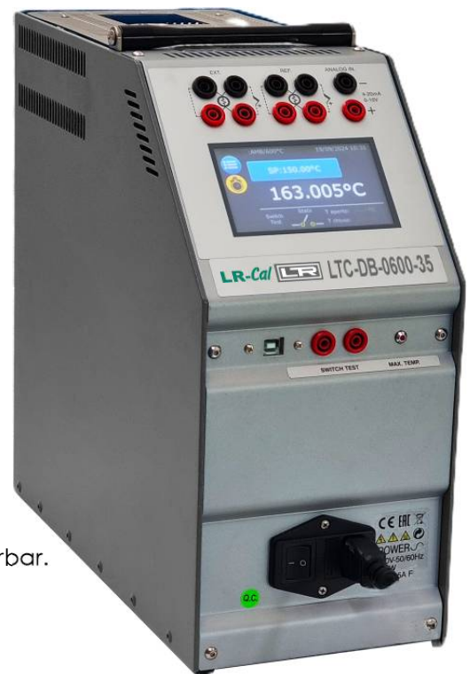
Die Abbildung zeigt den Kalibrator inklusive der Option LTC-MP-3I
