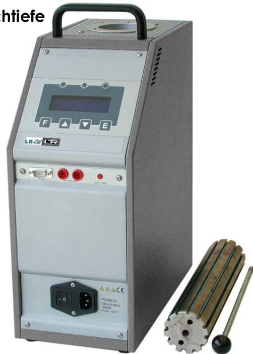
Das spezielle Ventilationssystem des LR-Cal LTC-DB-0550-60 sorgt dafür, dass die Temperatur über dem Block niedrig bleibt. Somit können auch Prüflinge mit kürzeren Eintauchlängen kalibriert werden, ohne dass sich der Griff oder Kopf des Prüflings zu stark erhitzt. Der Kalibrator wird durch einen PID Mikroprozessor-Controller gesteuert und bietet eine Auflösung bis zu 0,01°C. Als Temperatureinheiten stehen °C, °F und K zur Auswahl. Steigende und fallende Rampen können programmiert werden.
