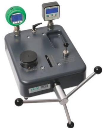
Die Druckvergleichsprüfpumpen der Modellreihe LR-Cal LSP-H sind mit Schmutzsieben an den Druckanschlüssen sowie einem Sinterfilter Reservoirboden ausgestattet. Somit wird die Verschmutzungsgefahr des Betriebsmediums erheblich verringert.
