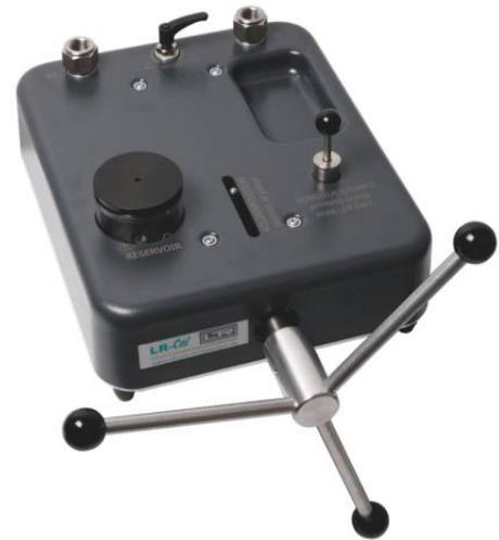
Die Druckvergleichsprüfeinrichtungen der Typenreihe LR-Cal LSP-H zeichnen sich durch eine nur innerhalb des Pumpenkörpers laufende Drehspindel aus. Damit entfällt ein nachteiliges Biegemoment auf eine herausgedrehte Spindel und speziell für den Einsatz vor Ort besteht außerdem der Vorteil, dass sich die Abmessungen der Druckvergleichsprüfpumpen während des Betriebs durch Drehen der Spindel nicht verändert.
