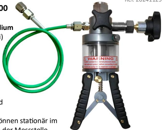
Die Kalibrier-Handtestpumpe **LR-Cal LPP 1000** dient zur Druckerzeugung für die Überprüfung, Justage und Kalibrierung von mechanischen und elektronischen Druckmessgeräten durch Vergleichsmessungen. Diese Druckprüfungen können stationär im Labor, Werkstatt und vor allem auch vor Ort, an der Messstelle stattfinden.
