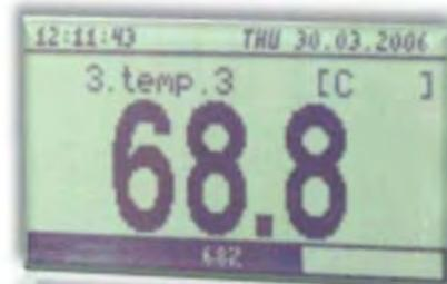
Einzelkanaldarstellung mit skaliertem und normiertem Messwert, Bargraph und Einheit
