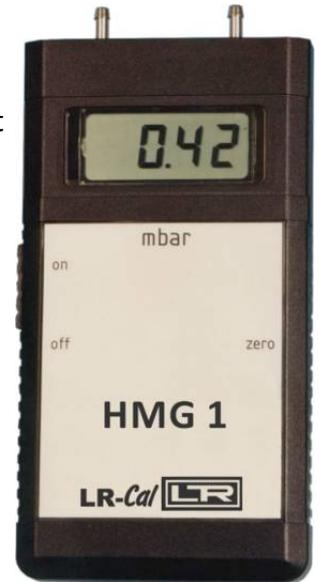
Die Digital-Handmanometer **LR-Cal HMG 1** sind zur Messung von nicht korrosiven und trockenen Gasen geeignet, z.B. Luft, trockene Gase.
