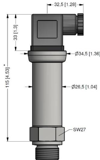
\* für Nenndruckbereiche  $p_N > 40$  bar erhöht sich die Länge der Geräte um 9 mm
