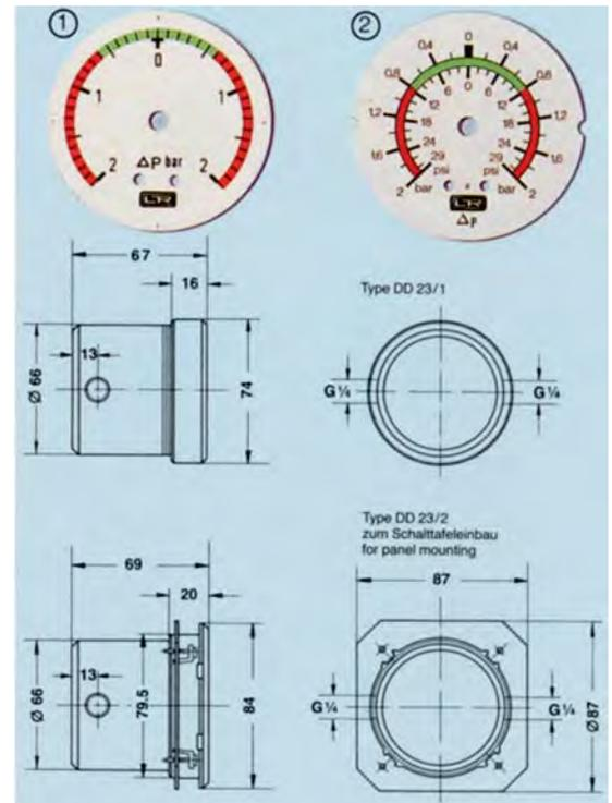
Für alle gasförmigen, nicht aggressiven Medien geeignet. Speziell zur rechtzeitigen Erkennung des Verschmutzungsgrades von Luftfiltern. Die besonderen Vorteile sind der für Differenzdruckmanometer sehr kleine Gehäusedurchmesser, die **direkte** Anzeige des Differenzdruckes, die sehr übersichtliche Skala mit Farbmarkierungen grün und rot für Arbeits- und Warnbereich und die von der Strömungsrichtung unabhängigen Anschlüsse.
