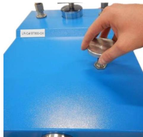
Vordruck-Absperrventil LR-Cal BT800-OX
