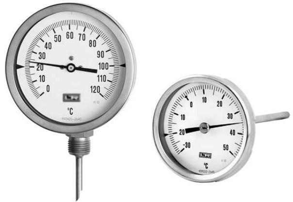
Bei den Bimetall-Zeigerthermometern Typ 06.TB7 aus Edelstahl handelt es sich um preiswerte, dabei robuste, für den Freilufteinsatz geeignete Temperaturmessgeräte für eine Vielzahl industrieller Anwendungsbereiche, z.B. in der Lebensmittel- oder chemischen Industrie. Der Taucher ist fest mit dem Gehäuse verschweißt (Argonarc). Die Thermometer Typ 06.TB7 sind, je nach Ausführung, in den Gehäusegrößen NG 63, NG 80, NG 100 und NG 125 lieferbar.
