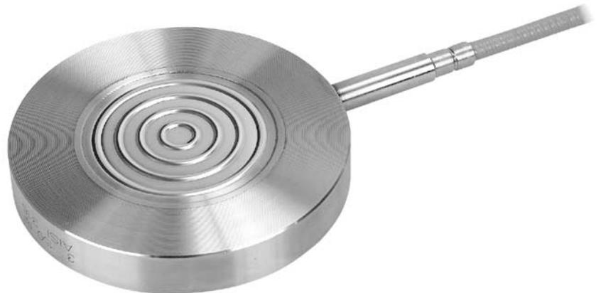
Druckmittler sind Trennvorlagen, die ein Eindringen von korrosiven, viskosen, aggressiven oder zu heißen Prozessmedien in das Messelement eines Druckmessgerätes verhindern. Die eingeschweißte Membran trennt die Übertragungsflüssigkeit zuverlässig vom Druckmessgerät. Das Druckmessgerät wird über eine Fernleitung (Länge bis zu 6 m) angeschlossen. Zellendruckmittler Typ 04.WAF werden in Flansche passender Nennweite (DIN oder ANSI) eingespannt.
