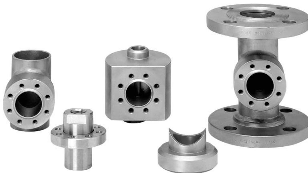
Druckmittler sind Trennvorlagen, die ein Eindringen von korrosiven, viskosen, aggressiven oder zu heißen Prozessmedien in das Meßelement des Druckmeßgerätes verhindern. Eine Membrane ist an das Druckmittleroberteil angeschweißt und trennt das Prozessmedium vom Druckmeßgerät ab. Die frontbündige Ausführung der Membrane ermöglicht eine einfache Reinigung der Oberfläche. Eine Auswahl von Anschlußstücken zum Anschweißen oder Anflanschen der Druckmittler an Rohrleitungen stehen zur Verfügung.
