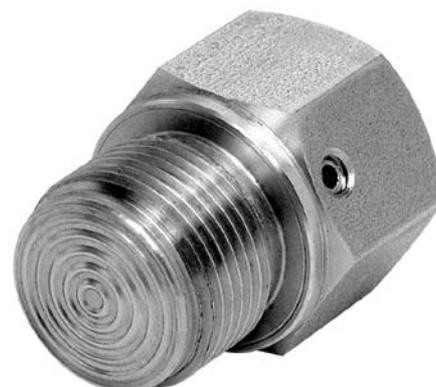
Druckmittler sind Trennvorlagen, die ein Eindringen von korrosiven, viskosen, aggressiven oder zu heißen Prozessmedien in das Messelement des Druckmessgerätes verhindern. Eine Membrane ist an das Druckmittleroberteil angeschweißt und trennt das Prozessmedium zuverlässig vom Druckmessgerät ab. Der Typ 04.367 ist für Manometer NG 63 und für Druckmessumformer geeignet. Er zeichnet sich durch seine besonders kompakte Bauform aus.
