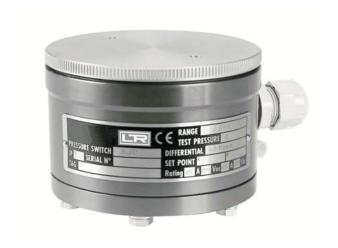
Die Plattenfeder-Druckschalter Typ 03.10 verfügen über die Schutzart IP 55. Bei dem Messglied handelt es sich um eine ansprechempfindliche Plattenfeder, welche über einen stabilen Stößel den Mikroschalter betätigt. Die robuste und einfach aufgebaute Konstruktion gewährleistet eine besonders lange Funktionssicherheit dieser Druckschalter.
