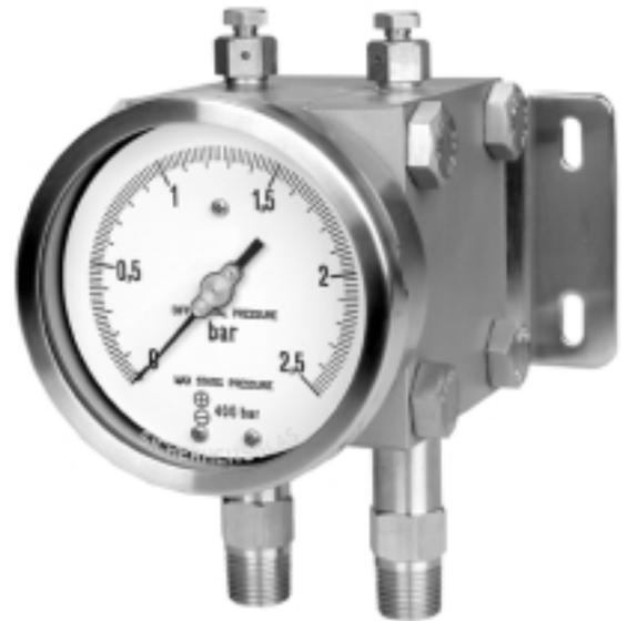
Die Plattenfeder-Differenzdruckmanometer Typ 02.17 eignen sich für Differenzdruckmessungen auch bei besonders hohen Betriebsdrücken (statische Drücke bis 400 bar), auch in aggressiver Umgebung. Sie zeichnen sich durch eine besonders hohe Überlastbarkeit (ein- und wechselseitig) aus. Sie sind für gasförmige und flüssige, auch aggressive, nicht hochviskose Medien geeignet.
