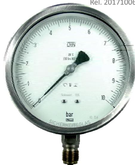
Feinmessmanometer **017.1.160** werden als Referenz bei Druckvergleichsmessungen zu Kalibrierzwecken eingesetzt. Sie finden jedoch auch dort Anwendung, wo es auf eine besonders hohe Genauigkeit und Reproduzierbarkeit der Messwerte ankommt. Sie sind für flüssige oder gasförmige, nicht kristallisierende Medien mit niedriger Viskosität geeignet, die Edelstahl AISI 316 nicht angreifen.
