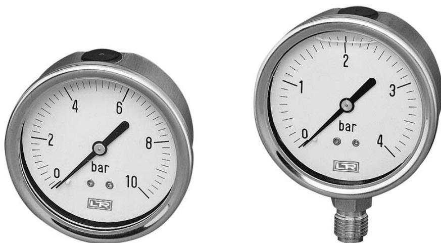
Die Rohrfedermanometer 01.18, komplett aus Edelstahl, eignen sich für gasförmige und flüssige, nicht hochviskose und nicht kristallisierende aggressive Medien. Sie sind in der mit Flüssigkeitsfüllung gedämpften Ausführung (01.18.3) besonders auch für Messstellen mit Vibrationen und hohen dynamischen Druckbelastungen geeignet. Die Dämpfungsflüssigkeitsfüllung verhindert auch Kondenswasserbildung und ein Eindringen korrosiver Gase in das Gehäuse.
