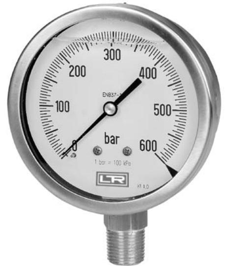
Die Rohrfedermanometer Typ 01.10: NG 100 sind für flüssige oder gasförmige nicht kristallisierende Medien geeignet, die Kupferlegierungen nicht angreifen. Die Variante mit Dämpfungsfüllungsflüssigkeit eignet sich insbesondere auch für erschwerte Einsatzbedingungen (Druckpulsationen, Vibrationen). Sie werden z.B. bei hydraulischen Anlagen, Pumpen, Hochdruckreinigern, Pressen, Kompressoren, Turbinen, Kühlanlagen, Elektrizitätswerken und Maschinen eingesetzt.
