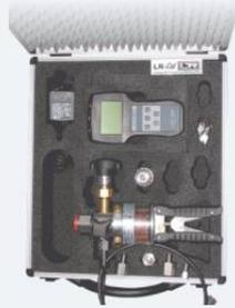
Raccord de pression pour la référence : en haut de la pompe 1/2" GAZ filetage femelle à écoulement libre, avec joint d'étanchéité.
