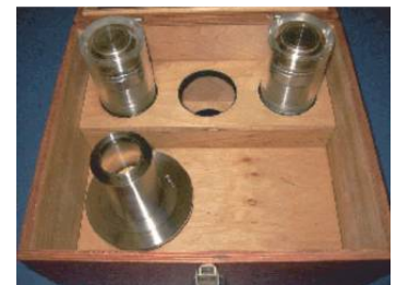
Système piston-cylindre et cloche du manomètre à pression LR-Cal LDW-P dans une caisse en bois en option
