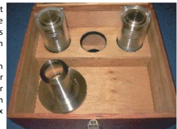
Système piston-cylindre et cloche pour la balance de pression LR-Cal LDW-P dans une caisse en bois en option
