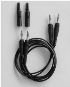
Kabel für Thermostat-/Temperaturschalter-Tests
