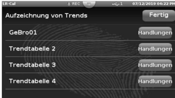
Dieser Menüpunkt ermöglicht eine grafische Anzeige der verschiedenen Ein- und Ausgangssignale. Sie können hier vier verschiedene Konfigurationen hinterlegen. Wählen Sie eine zur Bearbeitung aus, in dem Sie auf „Handlungen“ tippen. Die verschiedenen Trendtabellen können nicht gleichzeitig angezeigt werden.
