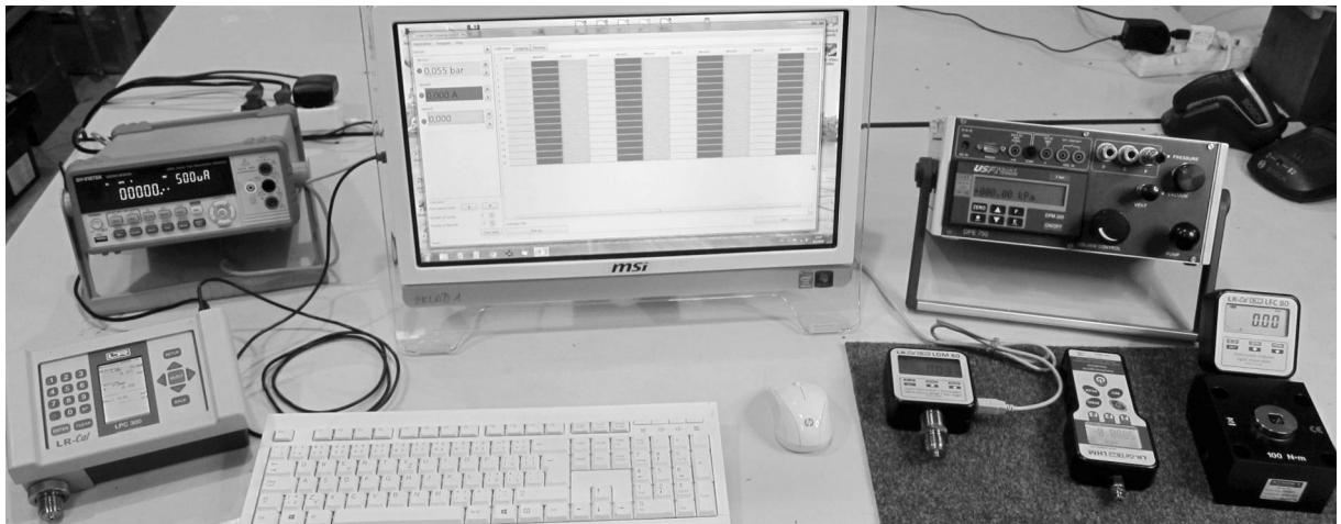
Bildschirm der LR-Cal LDM-COM Software nach Einstellung der Kommunikation mit drei Kanälen, im Kalibriertabellen-Modus.
