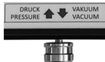
Druck-/Vakuum-Umschalter eingedrückt = Druck herausgezogen = Vakuum
