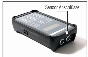
OPTIONAL: Anschlussmöglichkeit für einen weiteren Sensor. (Sensor nicht im Lieferumfang)
