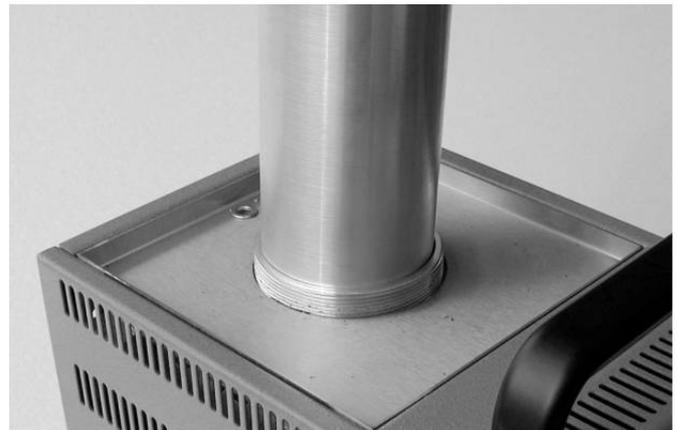
Die Aufheiz- und Abkühlgeschwindigkeiten erhöhen Sie bei Verwendung des Metallblock-Einsatzes. Nachfolgend eine Vergleichstabelle, die Daten wurden jeweils nach Erreichen eines stabilen Zustandes (Symbol „÷“ im Display) erfasst.
