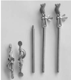
Haltesystem für Prüflinge (optimiert für Glasthermometer)
