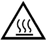
Der Temperaturkalibrator kann hohe Temperaturen erzeugen. Es besteht die Gefahr von Verbrennungen und Feuer. Halten Sie den Temperaturkalibrator fern von leicht entflammaren Materialien.
