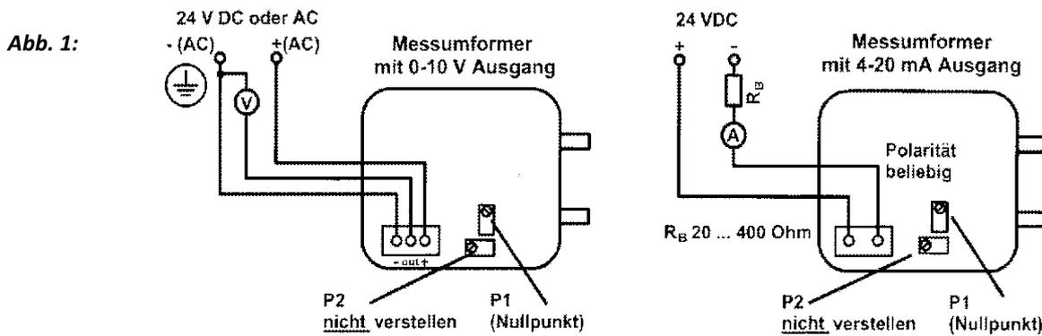
Der Ausgang der Variante mit Spannungsausgang ist kurzschlussfest gegen Betriebsspannung und Masse. Der Sensor ist gegen Überspannung geschützt. Die Variante mit Stromausgang ist gegen Verpolung geschützt.
