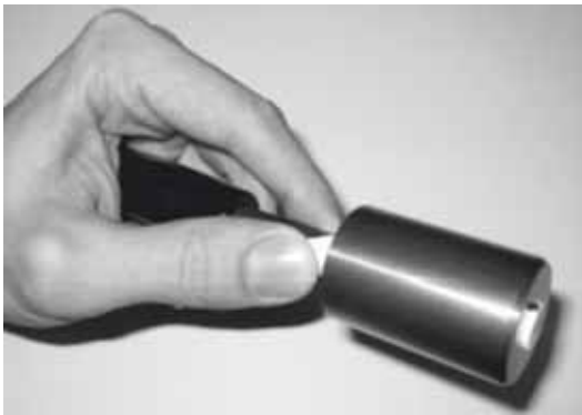
Bild 3: Zylinderreinigung: Reinigungsstift in Zylinderbohrung
