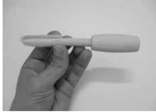
Bild 2: Zylinderreinigung: Reinigungsstift mit Baumwollstreifen
