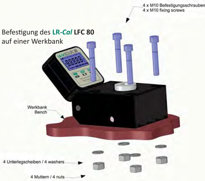
Das Display kann im Bereich 90° verstellt und fixiert werden.
