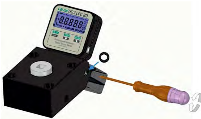
Das Display kann im Bereich 90° verstellt und fixiert werden.
