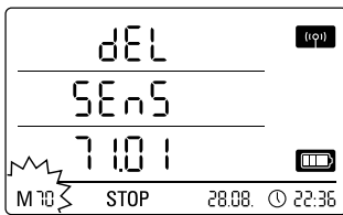
Anzeigebeispiel: Auswahl der Abmelfunktion M70 für die Abmeldung des zuerst angemeldeten Sensors.
