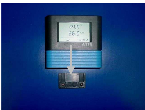
Bild: OPUS10 auf Haltewinkel schieben
