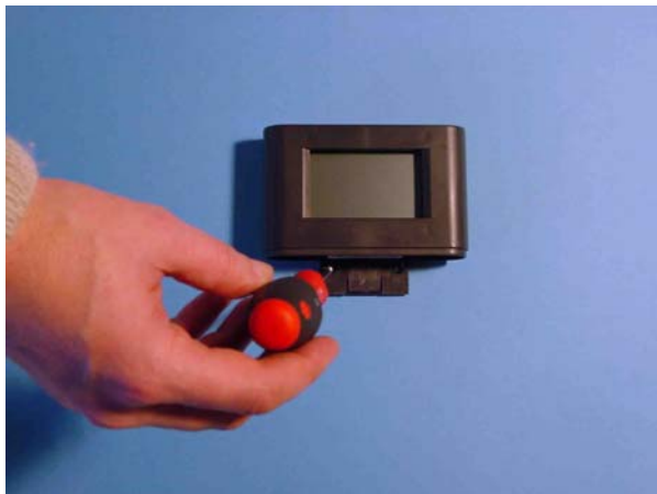
Bild: Befestigen eines OPUS 10
