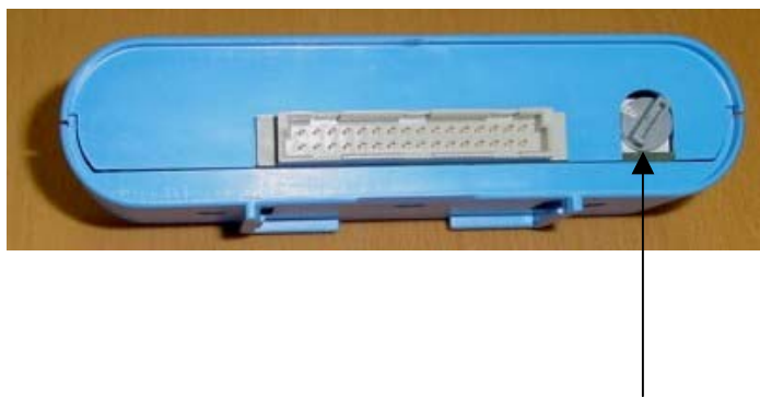
Drehschalter zur Einstellung des TC
