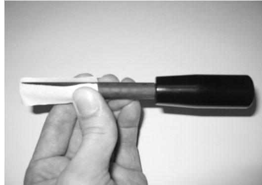
Bild 3: Zylinderreinigung: Reinigungsstift mit Baumwollstreifen
