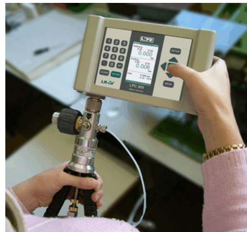
LPC 300 mit Kalibrier-Handtestpumpe LPP 30 im portablen Einsatz
